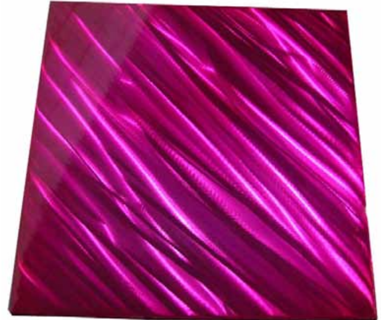
Bilde 22: Bordflate med farge og slipt overflate som gir struktur i stålet
