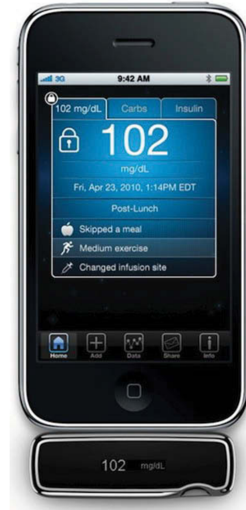
Fig 23. iBGStar Blood Glucose Meter fra Sanofi Aventis kan kobles til i-phone. Resultatene overføres til telefonen slik at man kan bruke telefonens software til å holde oversikt.
