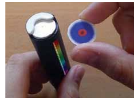
Fig 27. 4: Sammenligne fargeutslag med fargeskala på stikker.
