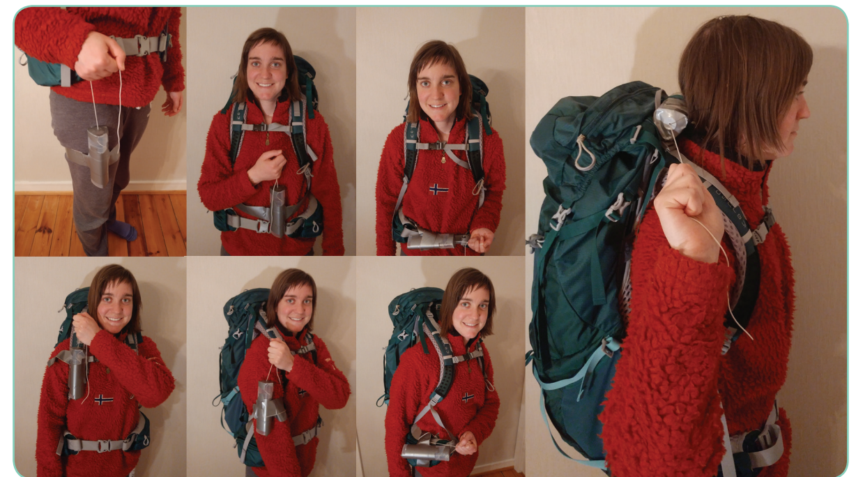
Illustrasjon 79: Enkel test av plassering av produkt ved hjelp av en "sketch model."
