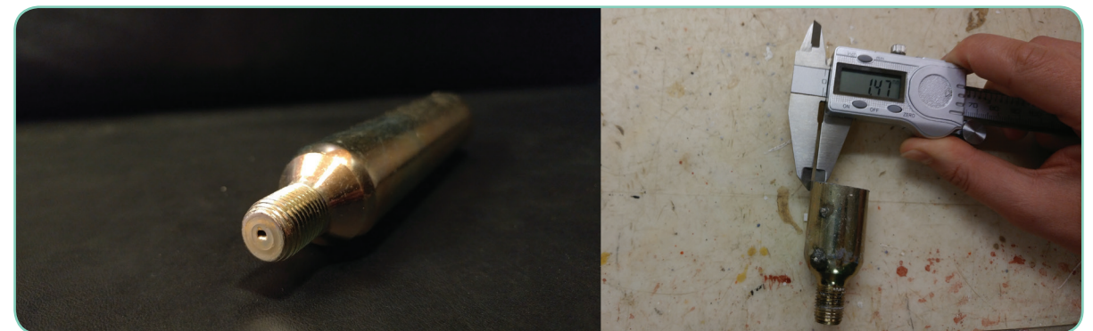
Illustrasjon 76: CO2-patron fra redningsvest og måling av godstykkelsen.
