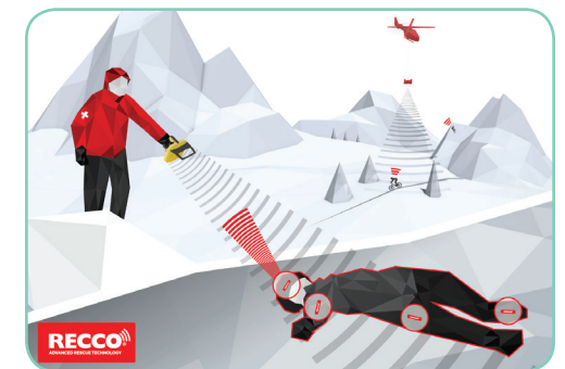
Illustrasjon 21: Illustrasjon av et recco-søk, der recco-brikkene reflekterer et radarsignal tilbake til recco-detektoren. Illustrasjon: Hentet fra artikkelen av Vodickova, 2017.
