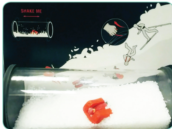
Illustrasjon 18: Modell på Oslo Sportslager som viser hvordan det er meningen at airbagen skal hjelpe den skredtatte med å flyte opp på snøen.
