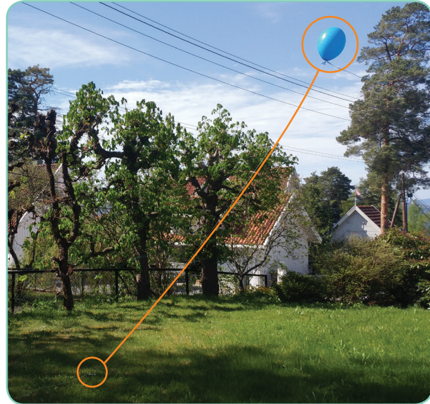
Illustrasjon 78: Enkel test av ballong og line ute i vinden. Dette er i et relativt vindstille øyeblikk med 4 m line.
