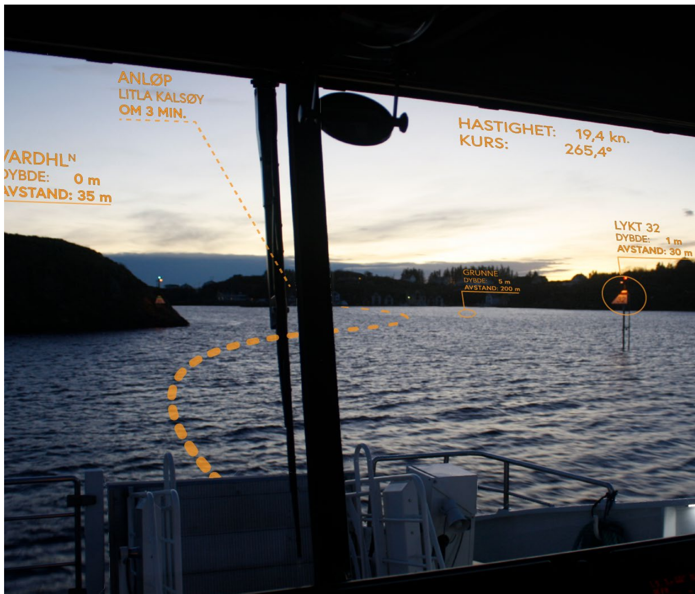
Skissen som ble vist navigatørene. Skissen illustrerer hvordan informasjon fra ECDIS kan projeksjoneres på broviduene.
