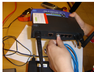
(d) Connection of the router to the Internet
