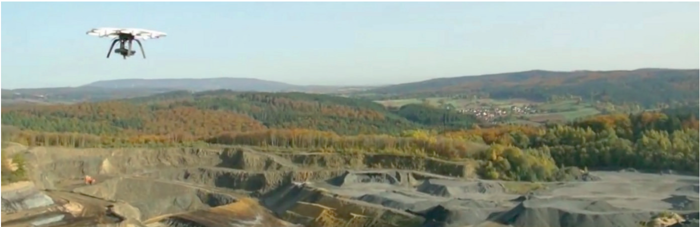
Aibot x6 i luften under oppdrag for å kartlegge et terreng
