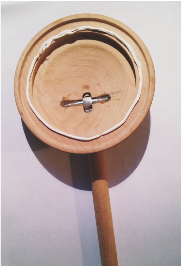
Figur 27. Vridningsleddet ble limt på plass med epoxy. Speil og lysdifusor ble limt på plass med TEC7.
