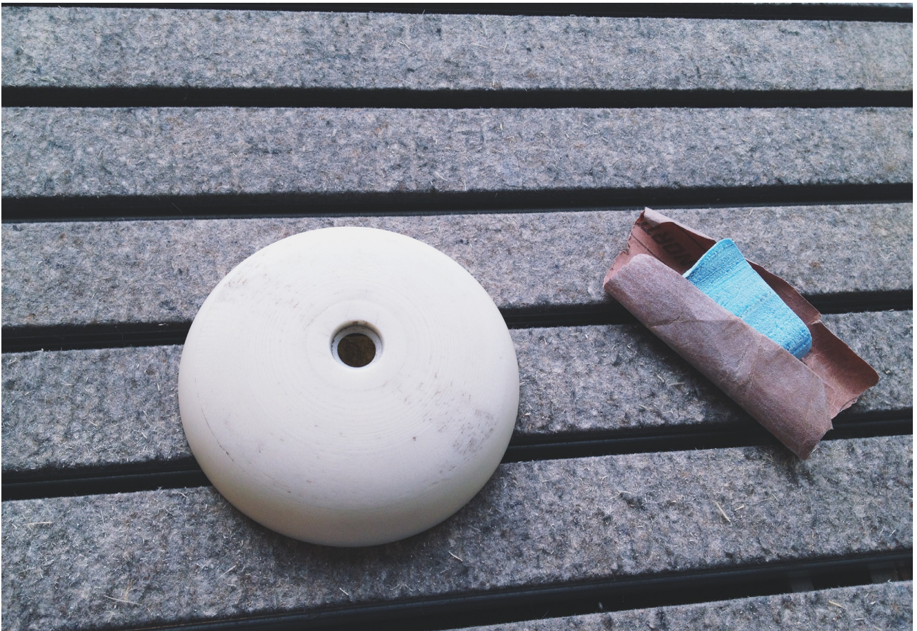
Figur 40. Selv om 3D-print gir en relativt god finish, måtte det flere runder med sandpapir og sparkel for å åpna en glatt overflate.
