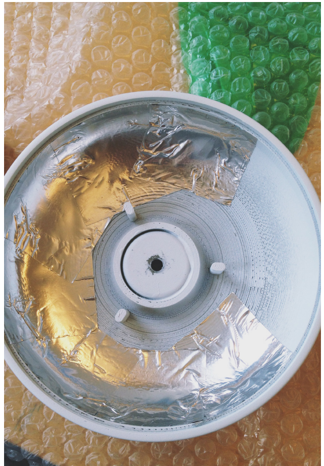
Figur 48. Innsiden av lampeskjermen ble kledd med aluminiumsteip for å unngå uønskede refleksjoner. Magneten i senter.
