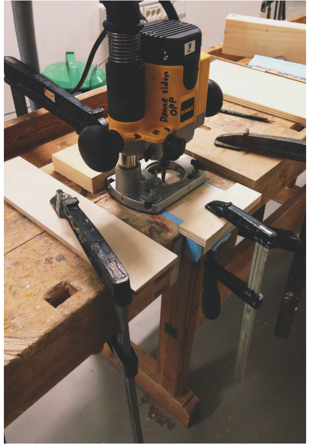
Figur 94. Hulrom til urverk freses ut med overfres og jigg.
