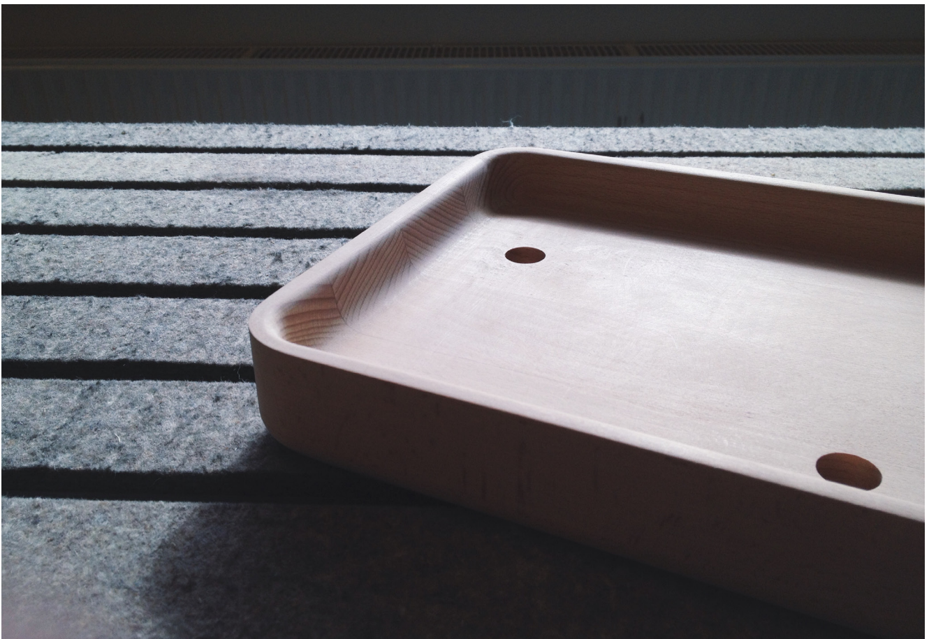
Figur 31. Emnet fatet ble frest ut av, består av fire sammenlimte staver. Dette ble gjort for å hindre at fatet skulle slå seg. Avrundingen langs bunnen av fatet ble frest ut ved hjelp av bordfres.
