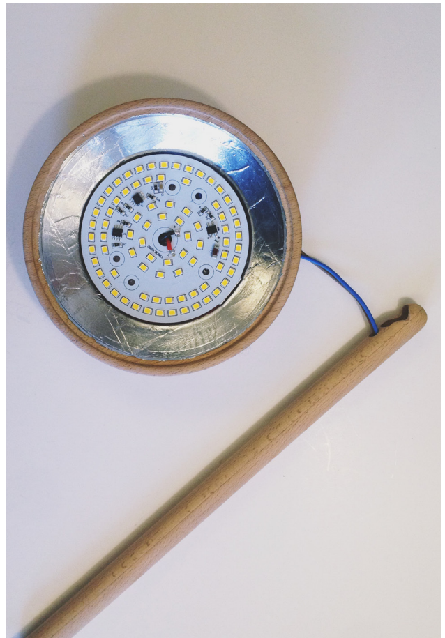
Figur 29. LED-lyskilde ble skrudd på plass. Loddepunkt mellom ledninger er skjult i stilken.
