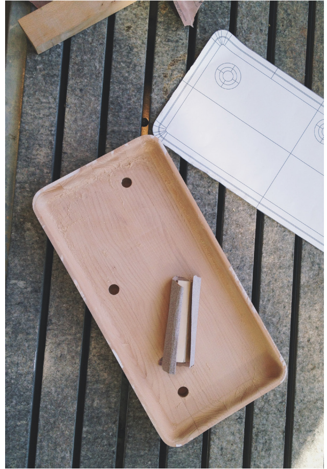
Figur 32. Den avsluttende CNC-fresingen lagde en mengde små spor i formen. Disse ble pusset vekk med sandpapir.
