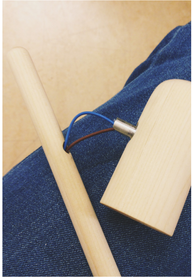
Figur 55. Aluminiumsdelen limes fast i trepinnen/stilken. Selve rotasjonen skjer i lampeskjermen.
