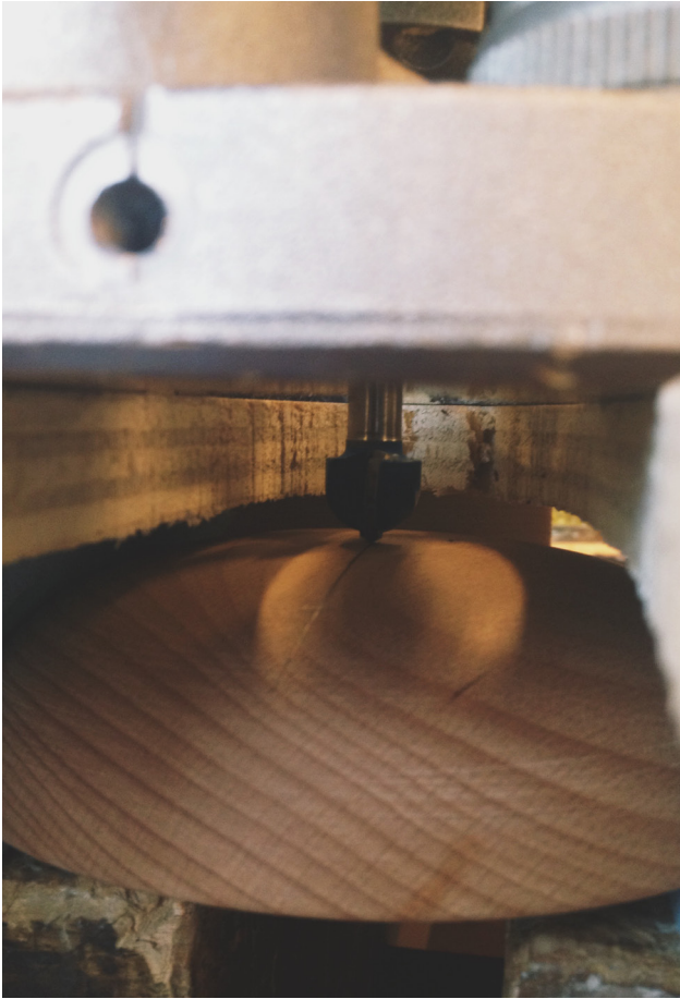
Figur 23. En solid jigg ble laget for å kunne frese ut spor med høy presisjon. Først fra baksiden, så fra innsiden.
