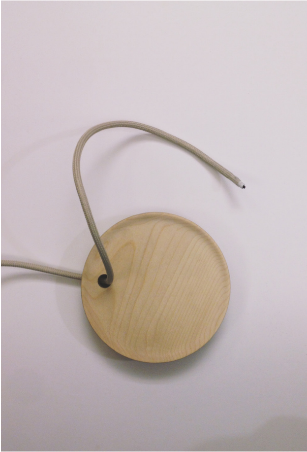
Figur 84. Tekstilledning ble trukket gjennom hullet i basen.
