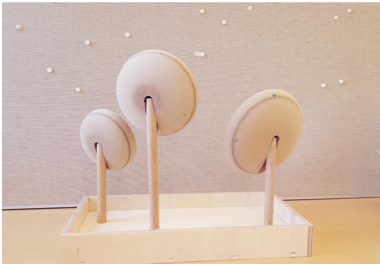
Figur 12. Mock-up i MDF og finerplater. Størrelsesforhold og plassering av speil og lamper blir testet. Inspirasjon fra wabi-sabi.
