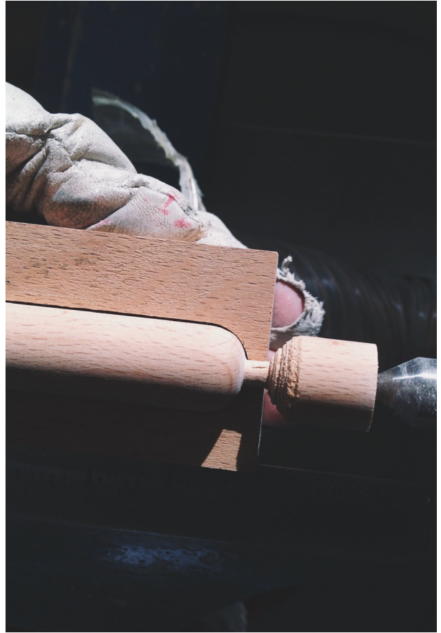
Figur 22. Pinnene eller stilkene til speilene ble rundet av i begge ender for å skape en god følelse ved interaksjon.
