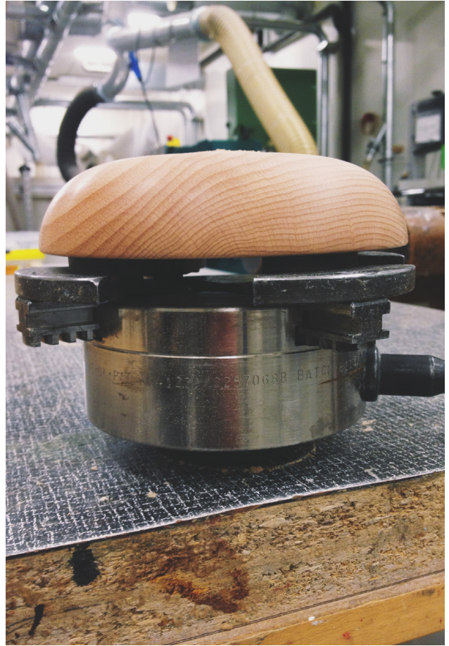
Figur 18. Emnene ble festet i en chuck for å kunne pusse baksiden jevn.
