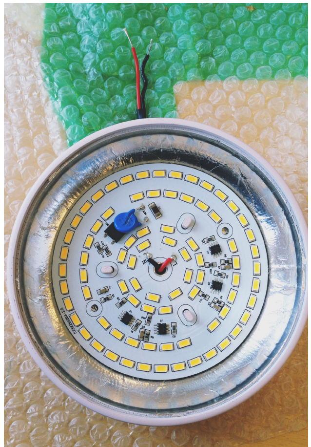
Figur 49. LED-disk på plass. Det ble designet festepunkter som gjør det mulig å dytte disken på plass. Nesten som en sokkel.
