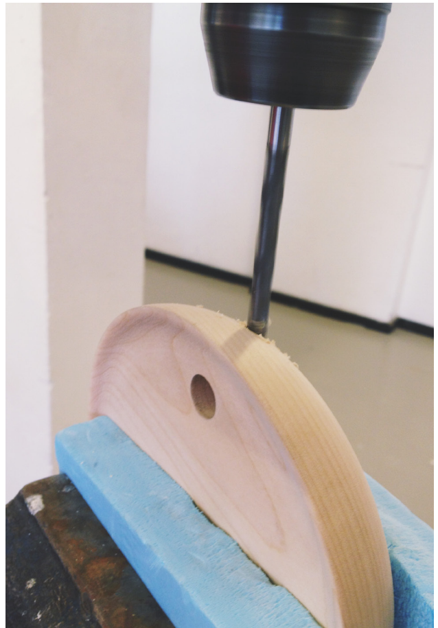
Figur 80. Hull til stilk og ledning ble boret på steder hvor de forstyrret treets spill med årringer, minst mulig.
