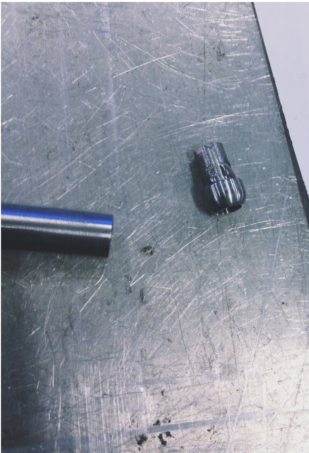
Figur 43. De avdreide og gjennomhulte endestykkene ble limt fast i stålrørene med epoxy.
