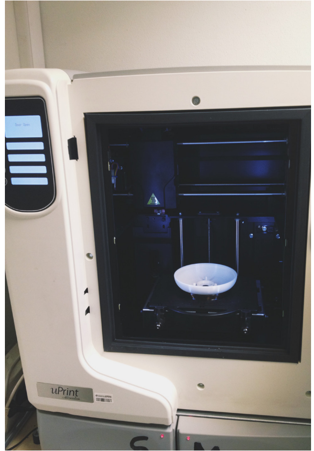
Figur 41. Lampeskjermene ble 3D-printet i ABS-plast på skolens CAD-verksted.
