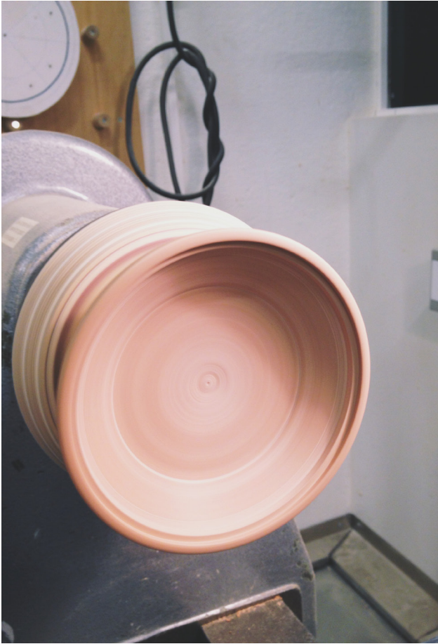
Figur 16. Innsiden av det som skulle bli lampe- og speilhodene, ble dreid først.
