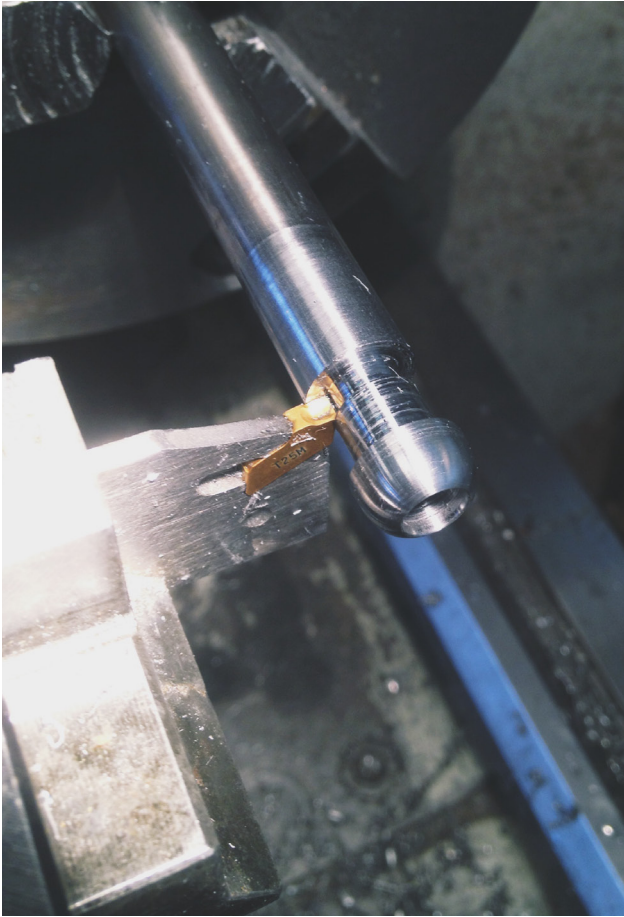
Figur 42. Med utgangspunkt i en stålbolt ble det dreid til endestykker.
