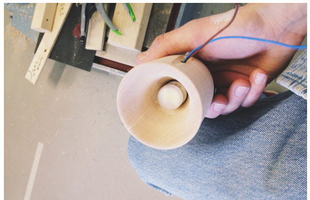
Figur 76. Testing av sokkel med pære og ledning.
