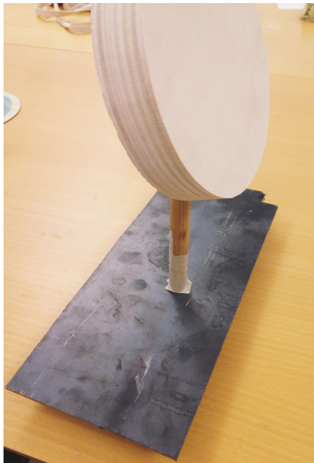
Figur 11. Funksjonstest av håndtak festet mot stålplate med magnet.
