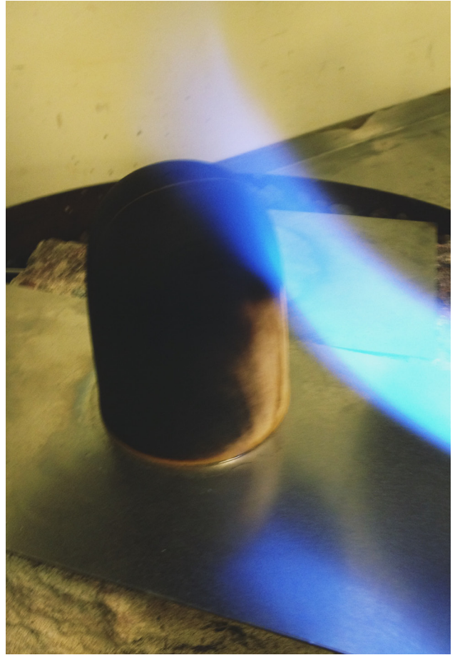
Figur 83. Delene ble gitt en superfisiell brenning med gassbrenner. Det er oljen som brenner slik at treet ikke forkulles.
