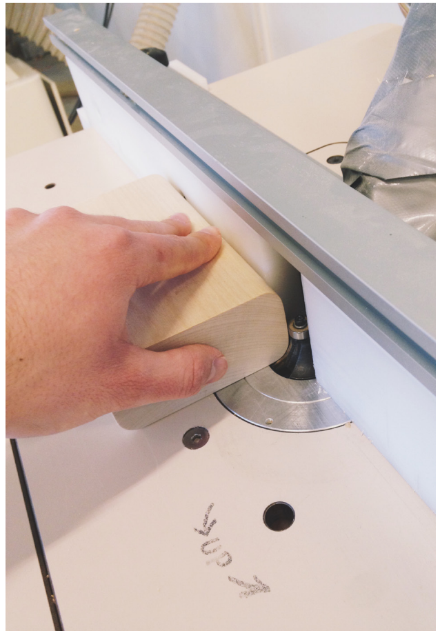
Figur 95. Bordfres blir brukt til å runde av langsiden.
