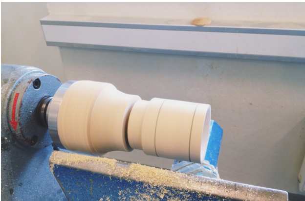
Figur 67. Hjelpelinjer ble brukt både til grovdreining og presisjonsdreining.
