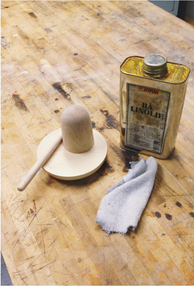
Figur 81. Første steg før brenning var å sette delene inn med rå linolje. Oljen fikk trekke inn i trevirket i ca. 20 minutter.
