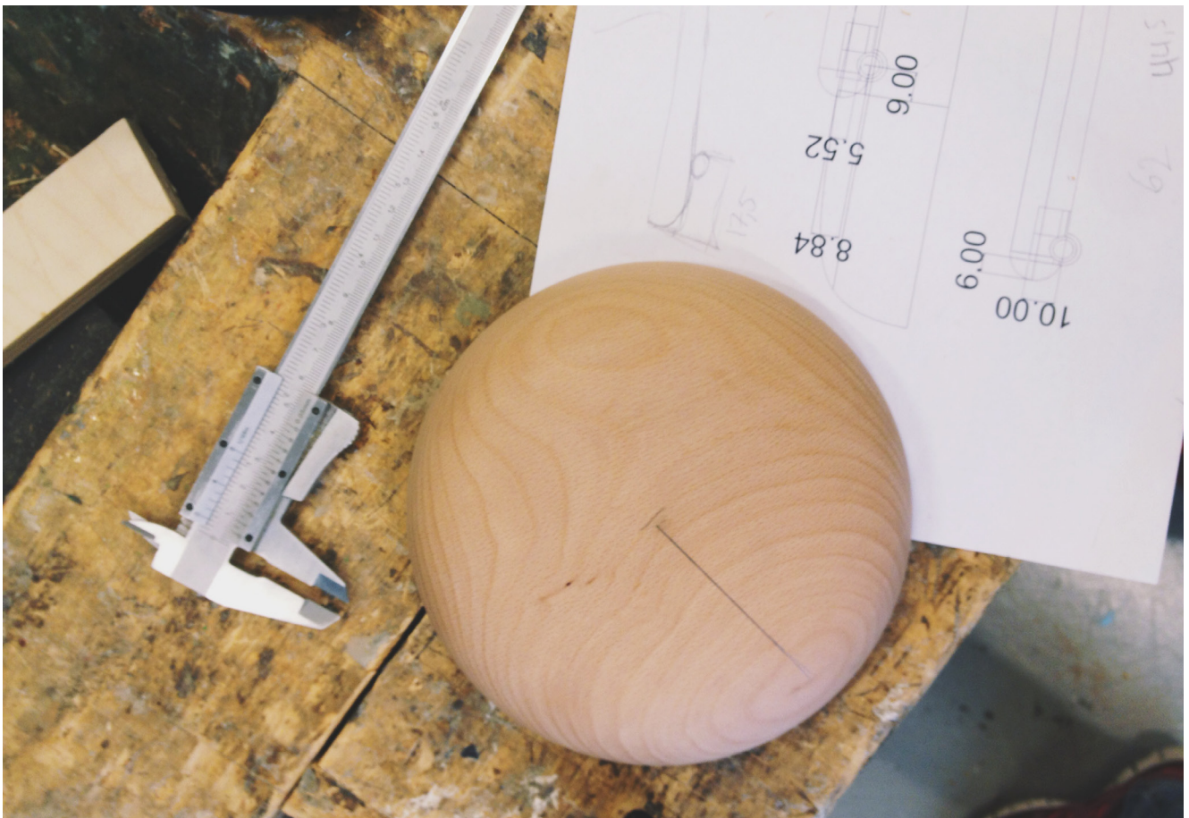
Figur 24. Arbeidstegninger ble også brukt som mal for å frese ut spor til stilkene og festepunktene i "hodene".
