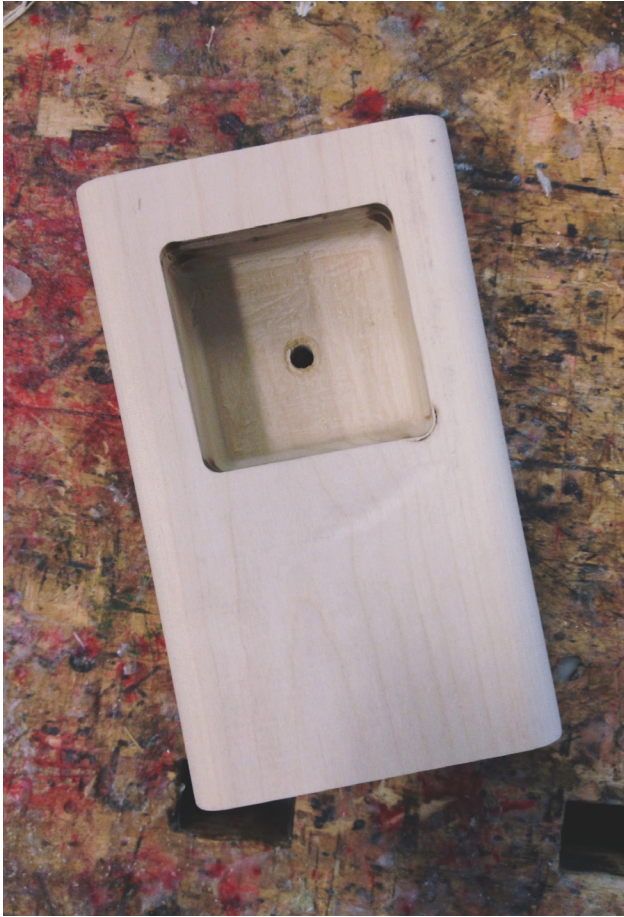
Figur 96. Her ser man det freste hulrommet og det lille hullet som lar senterfestet gå gjennom til forsiden.
