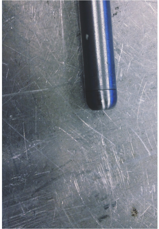
Figur 44. Endestykke på plass i stålrøret. For å gi et inntrykk av at stilkene var solide rør, ble skjøtene sparklet før lakking.
