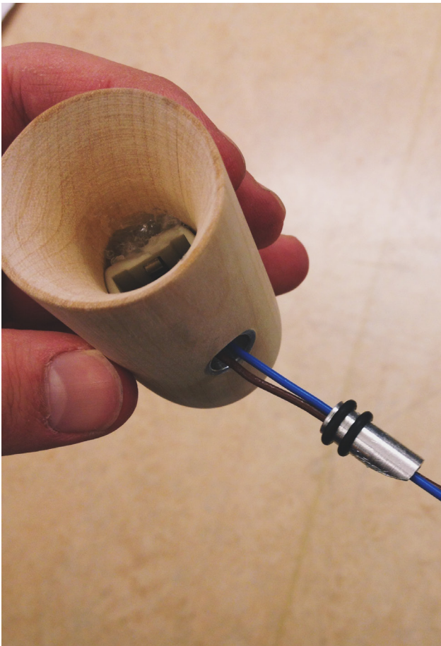
Figur 54. Pæresokkel limt på plass. Her kan man også se den dreide aluminiumsdelen med o-ringer som gjør rotasjonen mulig.
