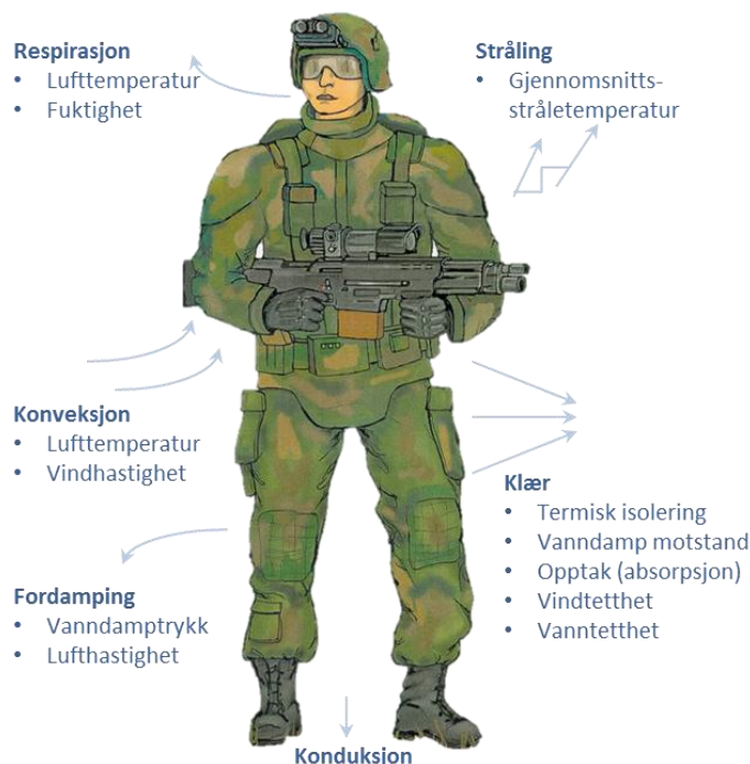
Figur 6 Forskjellige former for varmetap fra menneskekroppen. Teksten i figuren er hentet fra Figur 2 i "Håndbok for kulde", Holmér 2002 [79] og tegning ved FFI/Håkon Fykse.
