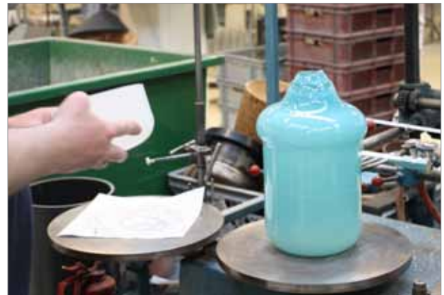
Figur 47: Formene sprenges/kuttes hos Magnor Glassverk.
