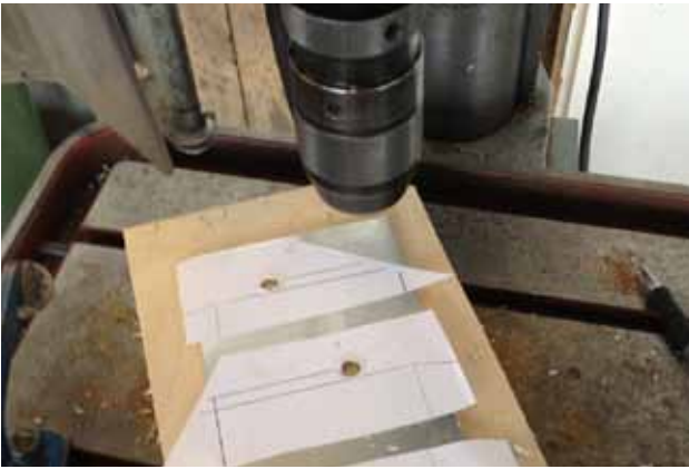
Figur 56: Test av brekkant på stativ. Ulike størrelser på hull og knekkpunkt ble prøvd ut.
