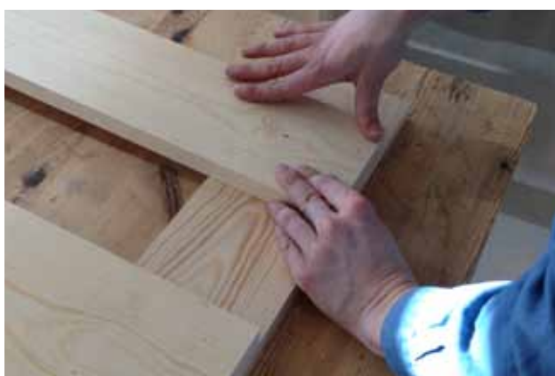
Figur 73: Snekring av bein til bord (Fotograf: Ole Erik Berget)
