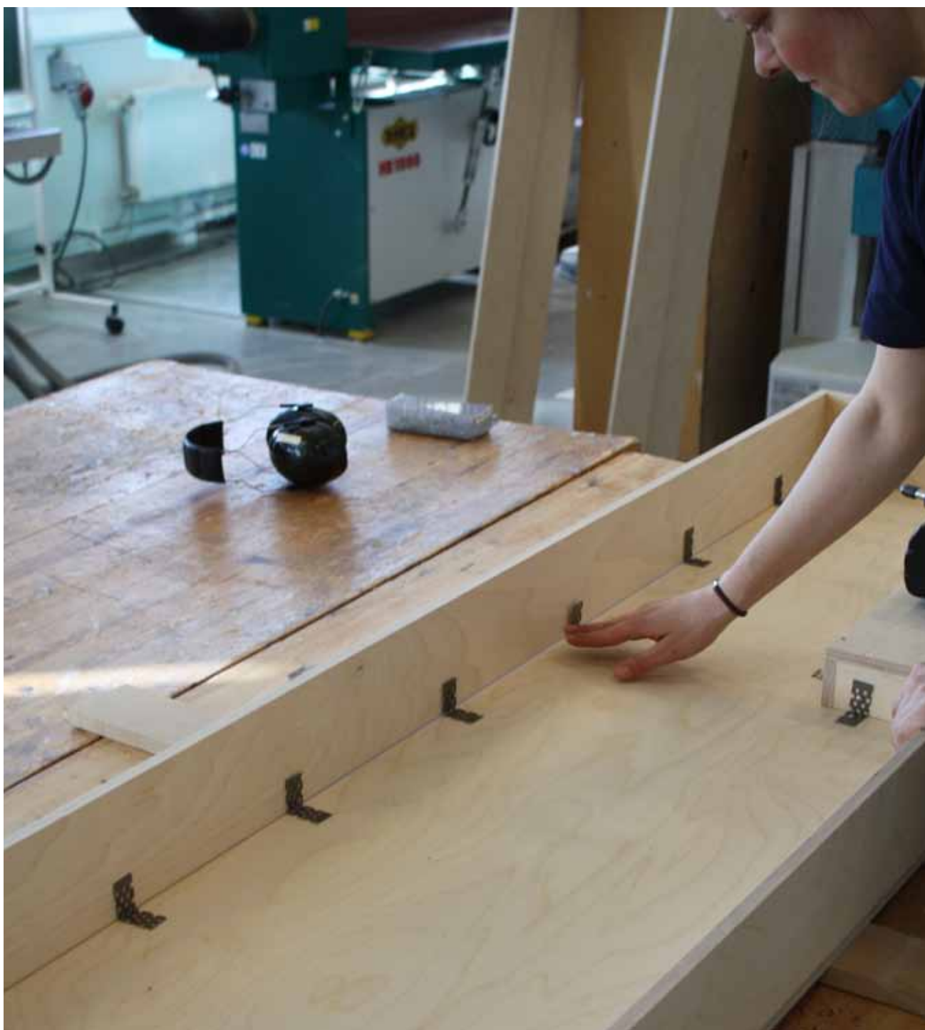
Figur 72: Utstillingsmodulene ble bygget av platemateriale i bjørk (se vedlegg). Toppen ble skrudd sammen på forhånd, mens benene ble flatpakket for transport. (Fotograf: Ole Erik Berget)
