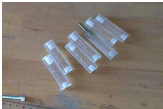
Figur 45: Forlenging av dimmer med akrylstav.
