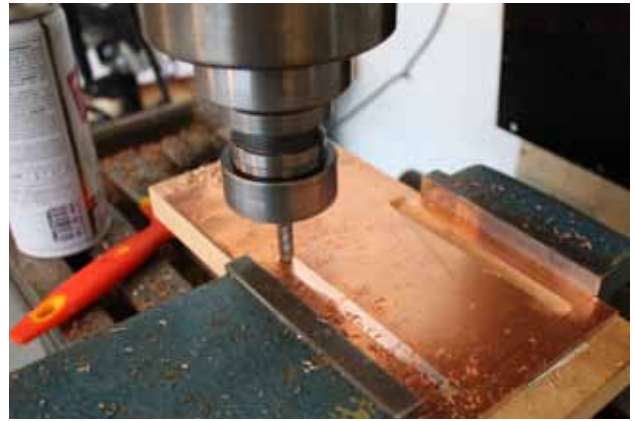
Figur 22: Fresing av glidebeslag - messing og stål.
