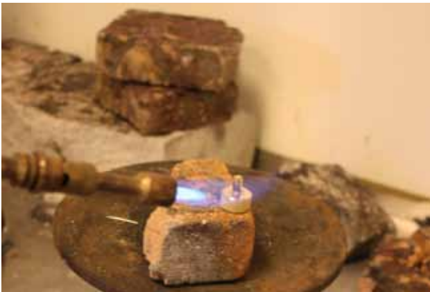
Figur 27: Gjengebolt i messing er loddet på den dreide delen i messing. Delene i aluminium er limt med epoxy.
