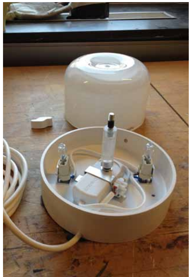
Figur 48: Switch slik den ser ut på innsiden. To pærer er plassert på hver side og dimmer er sentrert i midten.
