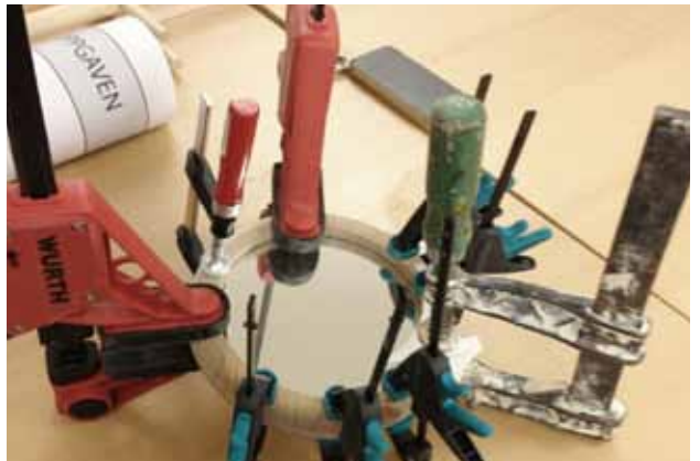
Figur 62: Liming av rammer.
