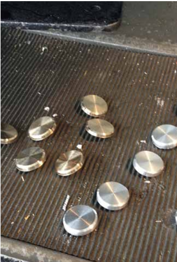
Figur 28: Delene er kantet for å vise at delen kun er for å føre glidebeslaget opp og ned. Skurdelen er også kantet for å gi et mer behagelig grep.
