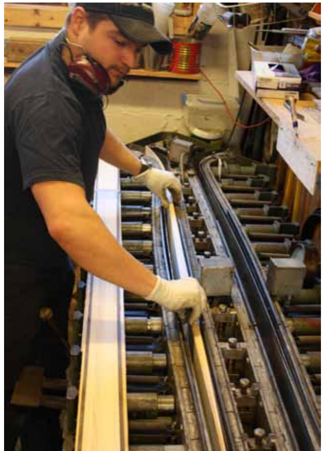
Figur 11: Laminering av treski hos Rønning. (Fotograf: Caroline Olsson)
