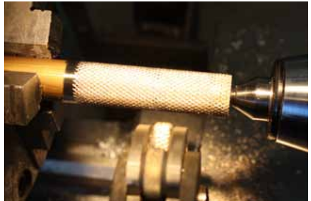
Figur 24: Serratering for bedre grep på skrudel.
