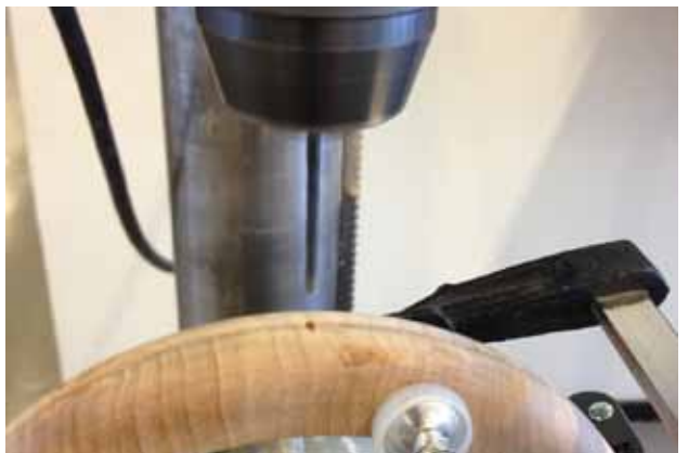
Figur 63: Bore hull til stativ, for nedfelling av gjengerør.
