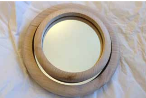
Figur 59: Rammer limt sammen med speil i midten.
